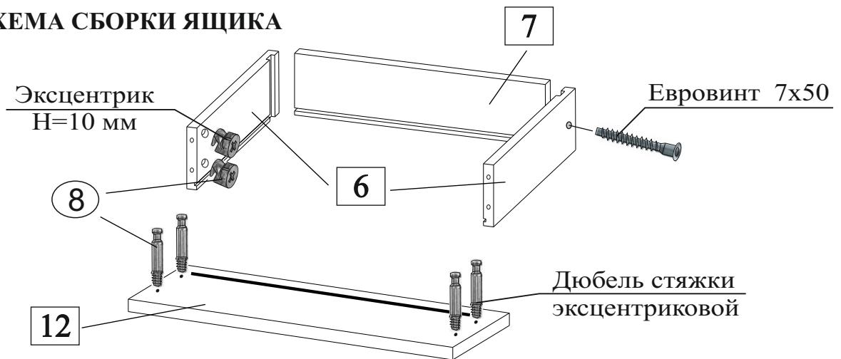
В накладку ящика вворачивается дюбель эксцентриковой стяжки. Ящик собирается согласно схеме, боковые и задняя стенки ящика стягиваются евровинтом 7x50.
